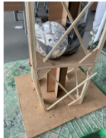
1층 기둥과 가새 파손
